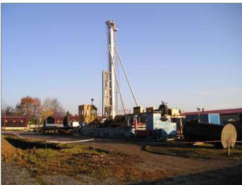
Obrázek 2 Vrtná souprava realizující ověřovací vrt do 2,1 km
