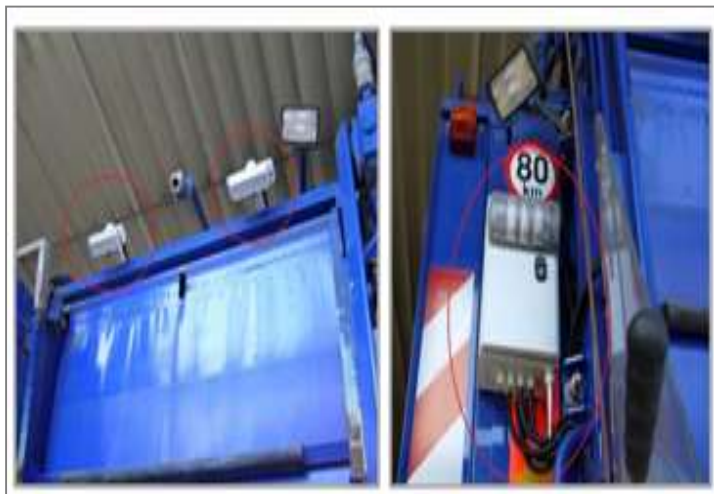
Obrázek 2 Umístění antén čtečky čipů a centrální jednotky s vizuálním a zvukovým výstupem
